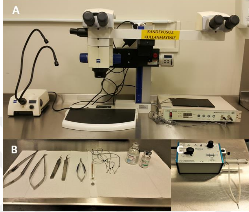
Resim 5.11.1. Cerrahi operasyon düzeneği. (A) Operasyonun yapıldığı mikroskop, (B) İntramiyokardiyal enjeksiyonda kullanılan cerrahi aletler, (C) Entübasyonda kullanılan ventilasyon cihazı.
