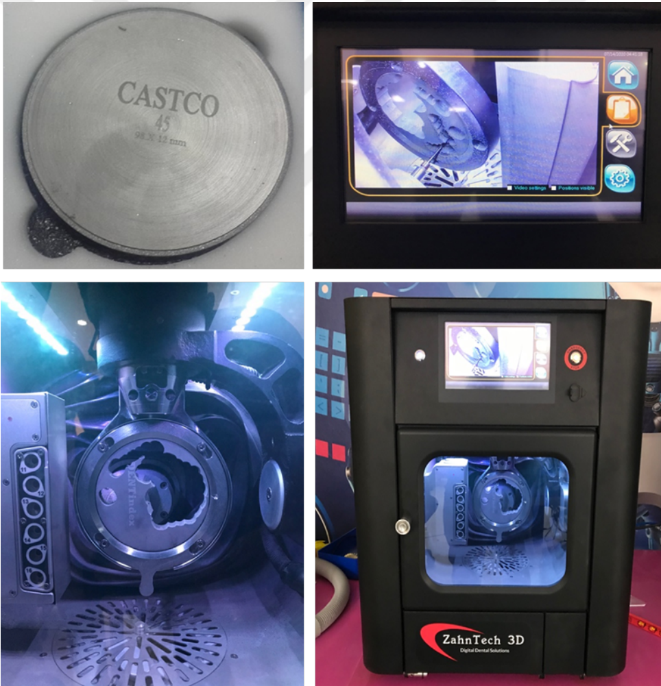
Resim 5.1.3. Zahntech 3D (Dentindex, İstanbul, Türkiye) cihazında CASTCO 45 98x12 blokların kazınması
