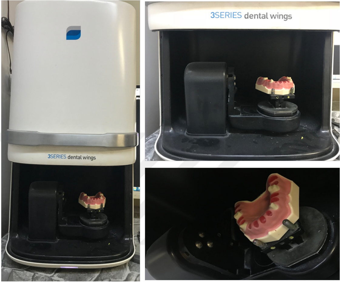
Şekil 5.6. Ana modelin Dentalwings 3Series (Montreal, Kanada) tarayıcı ile beraber STL (standard tessellation language – STL) formatında elde edilmesi
