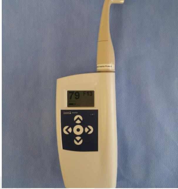
Resim 10. RFA ölçmek için kullanılan Osstell Mentor.
