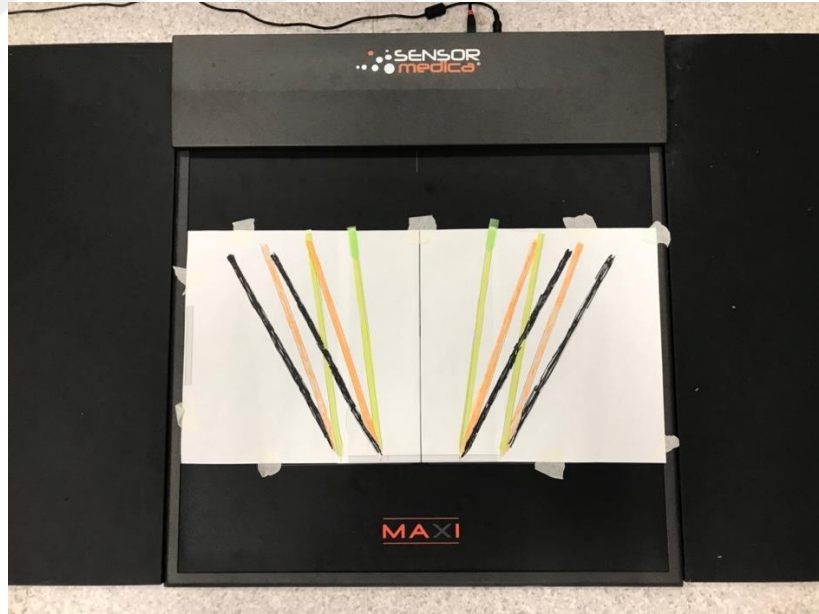
Resim 5.3.3. Bireylerin ayak eksternal rotasyonunun ayarlanması için düzenlenen sistem
