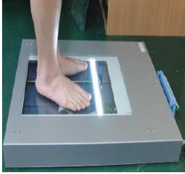
Resim 4.5.2.1. Statik Plantar Basınç Ölçüm Cihazı (85).
