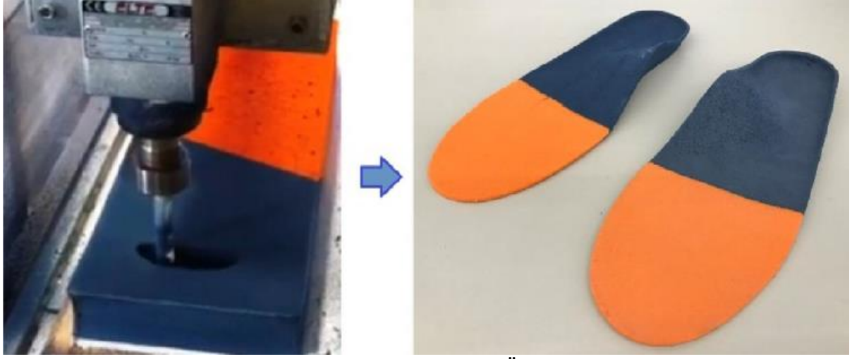
Resim 4.5.1.1. CAD / CAM Tabanlık Üretimi (83).
