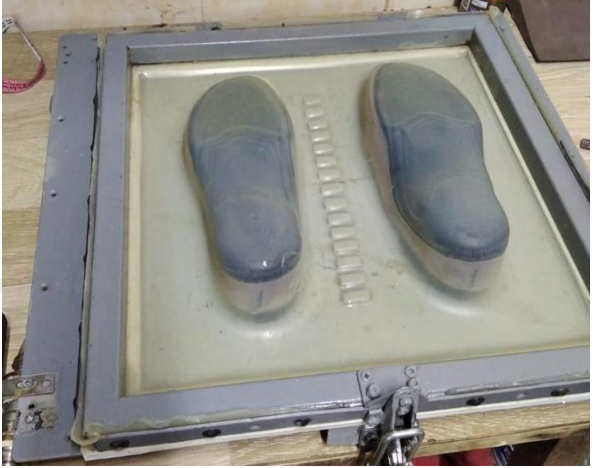
Resim 5.2.2.5. Karbon Tabanlık Press Vakum Aşaması
