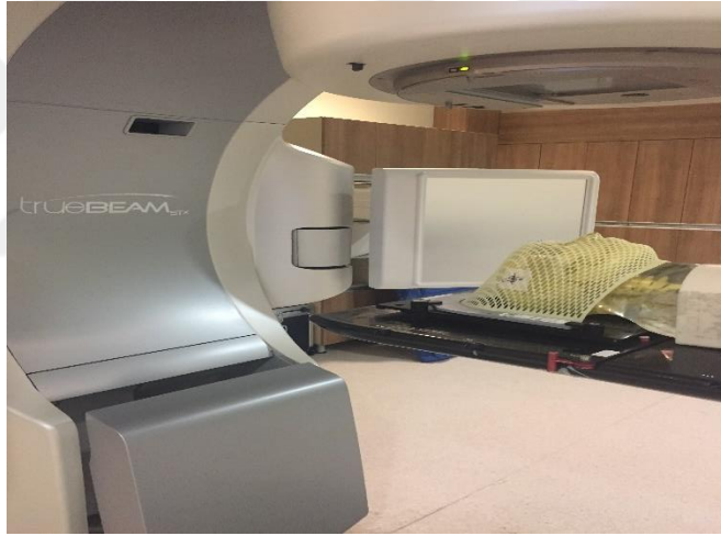
Resim 5.2.11.3. Film dedektörü kullanılarak Truebeam STx tedavi cihazı için tedavi öncesi head fantomunun başına orbit maske takılmış halinin setup görüntüsü
