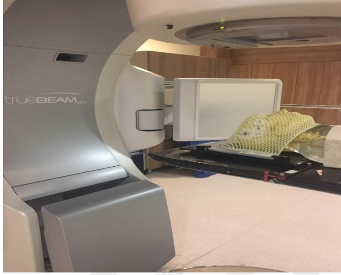
Resim 5.2.12.3. OSL dedektörü kullanılarak Truebeam STx tedavi cihazı için tedavi öncesi head fantomunun başına orfit maske takılmış halinin setup görüntüsü
