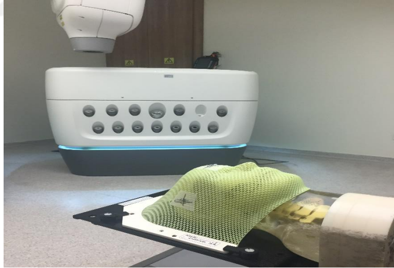
Resim 5.2.13.2. Film dedektörü kullanılarak Cyberknife M6 tedavi cihazı için tedavi öncesi head fantomunun başına klarity maske takılmış halinin setup görüntüsü
