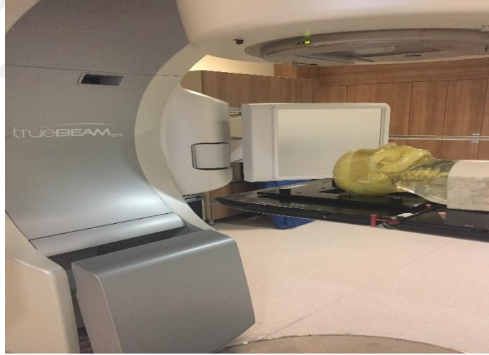
Resim 5.2.11.1. Film dedektörü kullanılarak Truebeam STx tedavi cihazı için tedavi öncesi head fantomunun maskesiz setup görüntüsü
