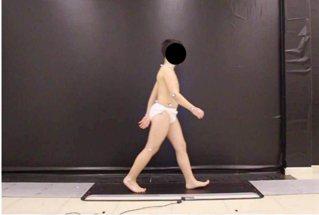
Resim 5.1. Win-Track® Pedobarografi cihazı.
