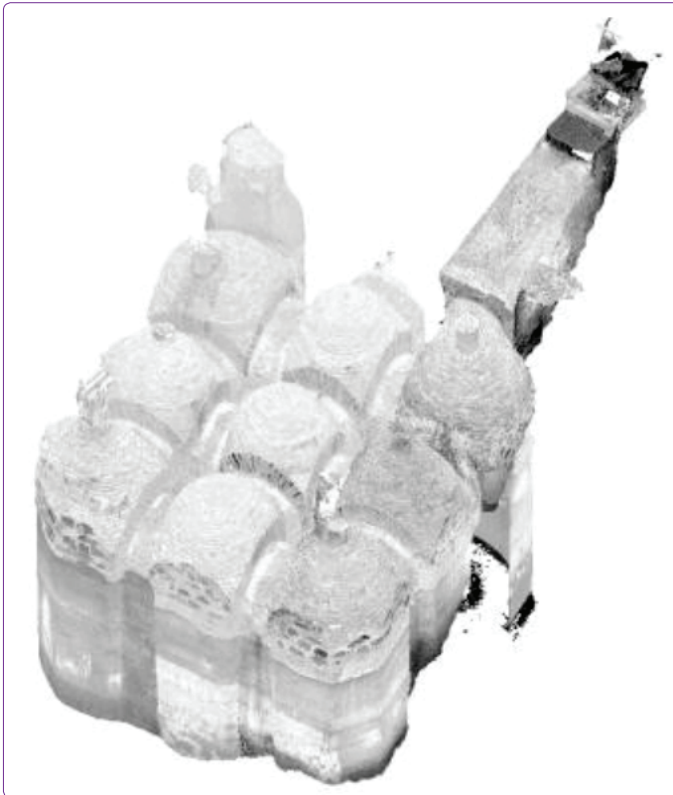
Şekil 10. Sarnıca ait birleştirilmiş nokta bulutu verisi, 2012. (Kaynak: MDM Mimarlık Ltd.).
