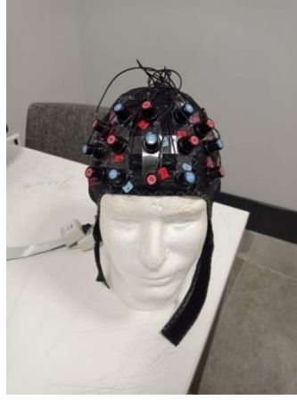
Resim 5.3. Optodların kep üzerinde montajı
