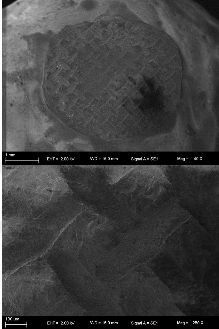
Resim 3.24: Opalseal grubuna ait ARI 2 skorlu mine yüzeyinin SEM görüntüsü
