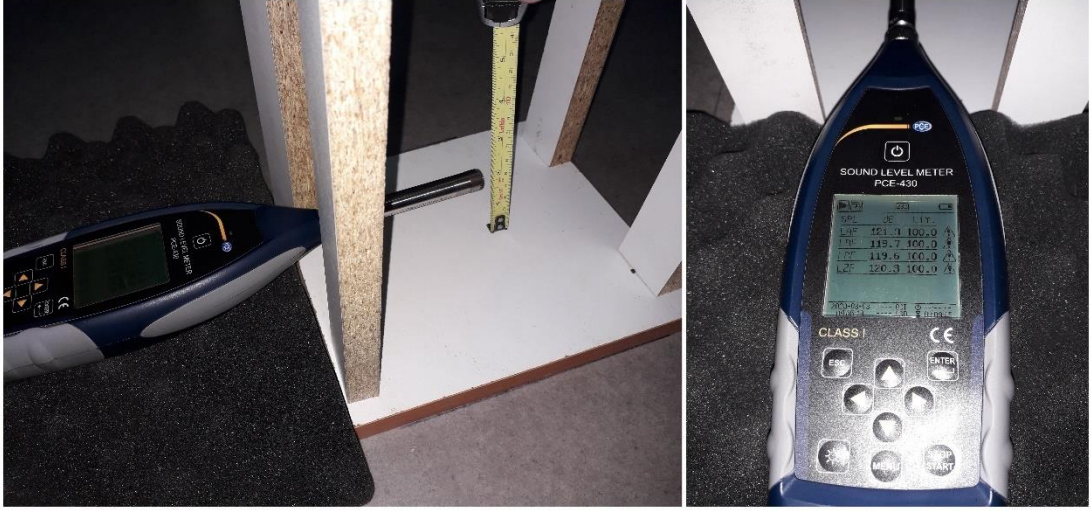
Resim 5.2. Hoparlör sisteminin kalibrasyonu.
