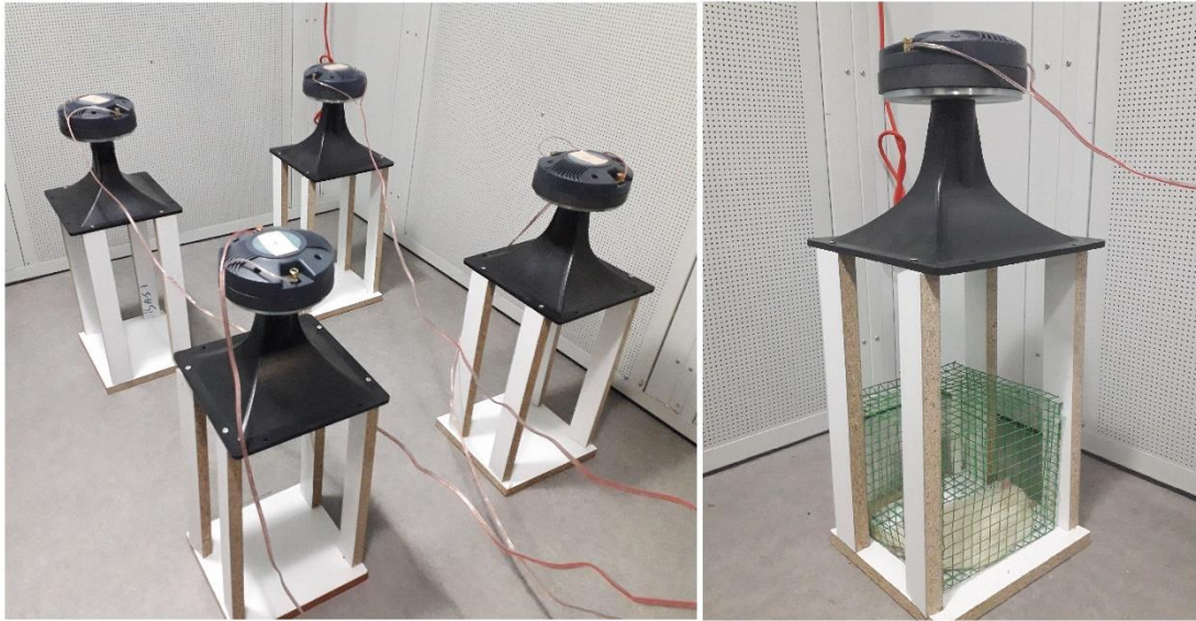
Resim 5.1. Hoparlör sisteminin kabin içerisinde konumlandırılması ve gürültü sunulması sırasında kafes içerisinde bir sıçan.
