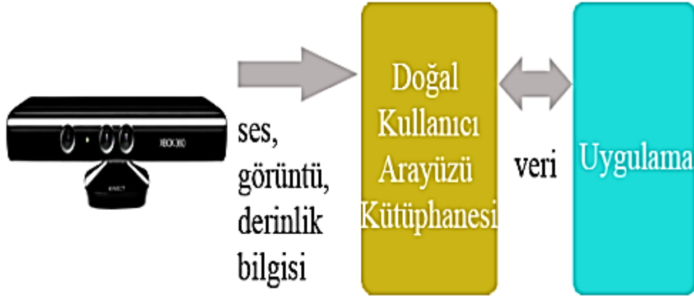
Şekil 4.3. Xbox Kinect Bilgi Akışı (62)
