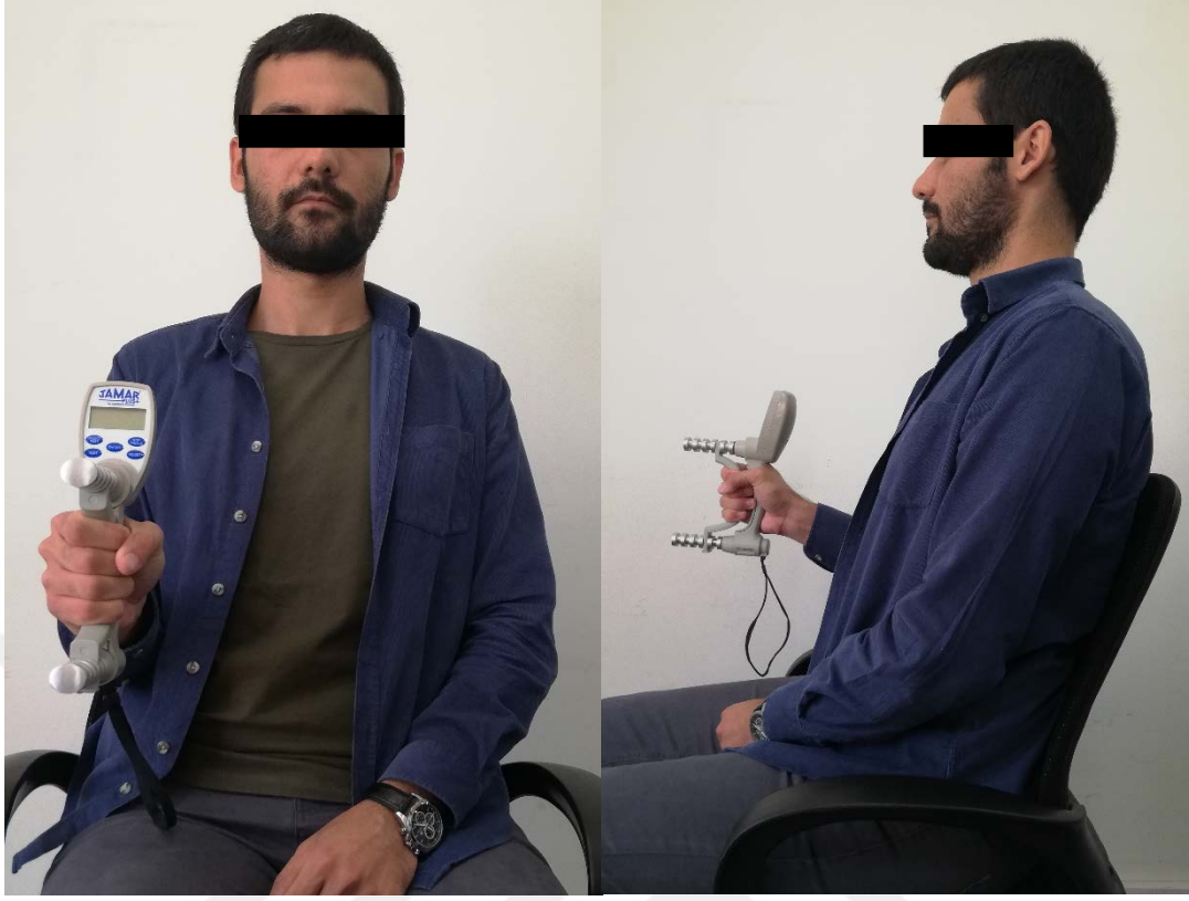
Resim 5.4.5.1. Kavrama kuvvetinin dinamometre ile ölçülmesi
