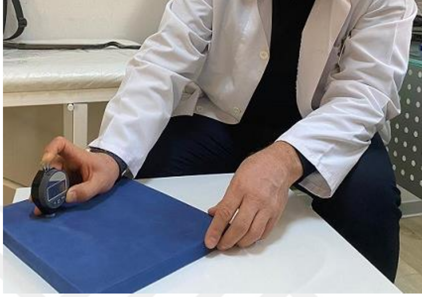
Resim 5.2.2.7 Malzeme Sertlik Ölçümü
