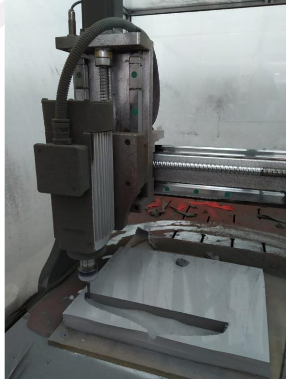
Resim 5.2.2.4 CNC Cihazından Tabanlık Üretimi
