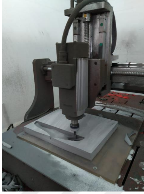
Resim 5.2.2.5 CNC Cihazından Tabanlık Üretimi
