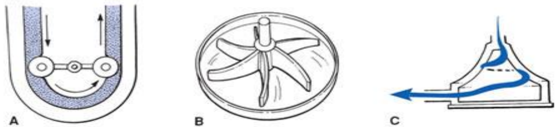
Resim 4.2. Kardiyopulmoner By-pass Cihazında kullanılan pompa çeşitleri
