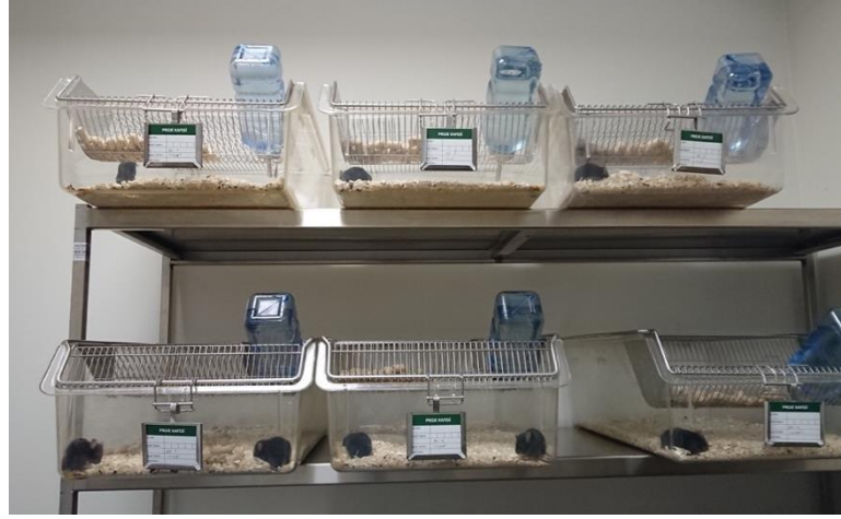
Resim 5.2.3.1. Dişi ve yerleşik erkek farelerin yerleştirildiği yerleşik- işgalci testi kafesleri.
