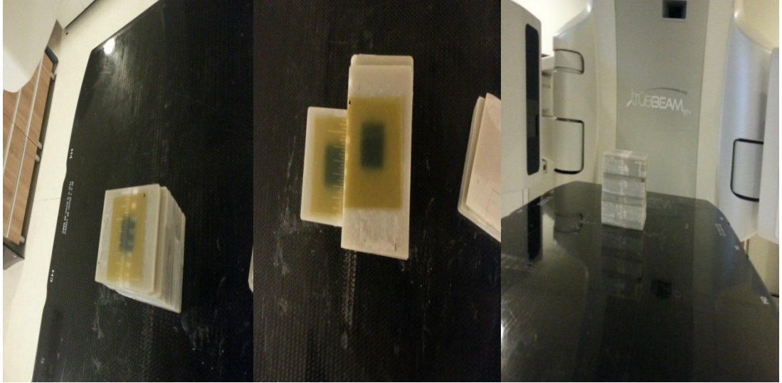
Resim. 5.2.4.1. Profil ölçümleri için hazırlanmış kemik fantom setup'ı
