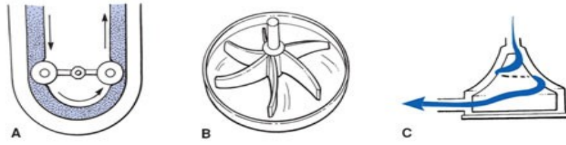
Resim 4.2.Kardiyopulmoner Bypass Cihazında kullanılan pompalar
