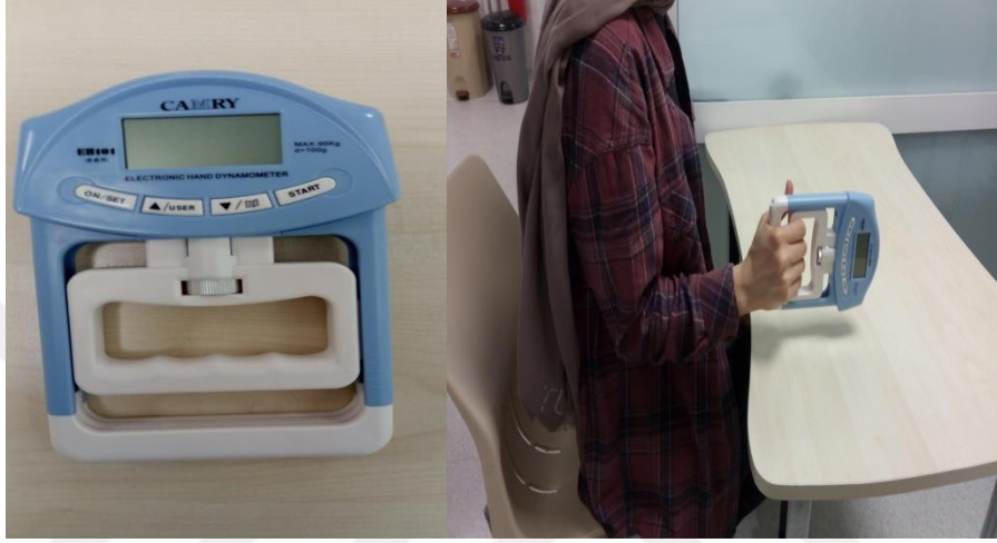
Şekil 5.2.1.1- Dijital El Dinamometresi ve Uygulama Şekli
