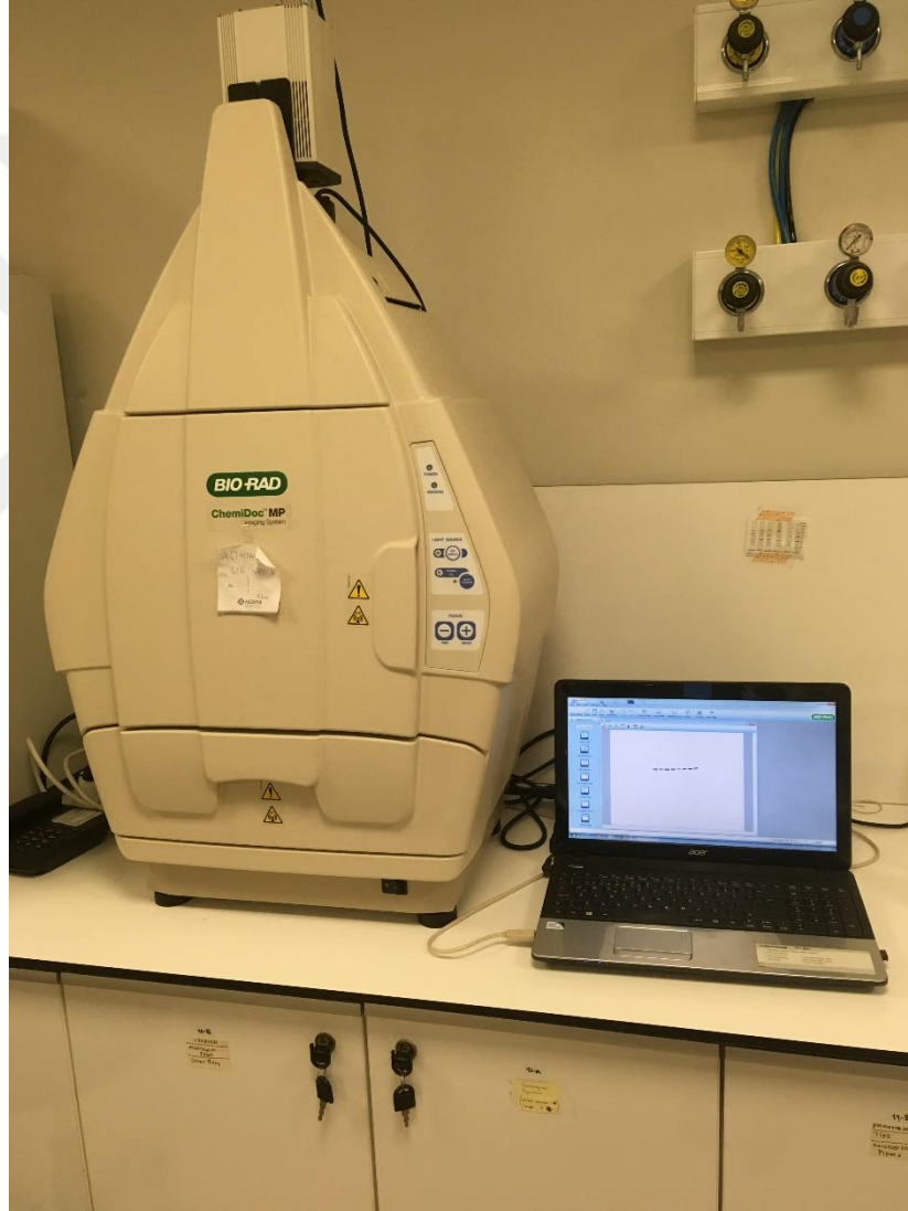
Resim 5.10.6.1. Chemidoc MP görüntüleme sistemi (1708280, Biorad Life Sciences Research, Kaliforniya, Amerika)
