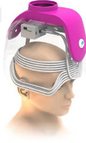
Resim 4.2.1: Derin TMU H7 bobini
