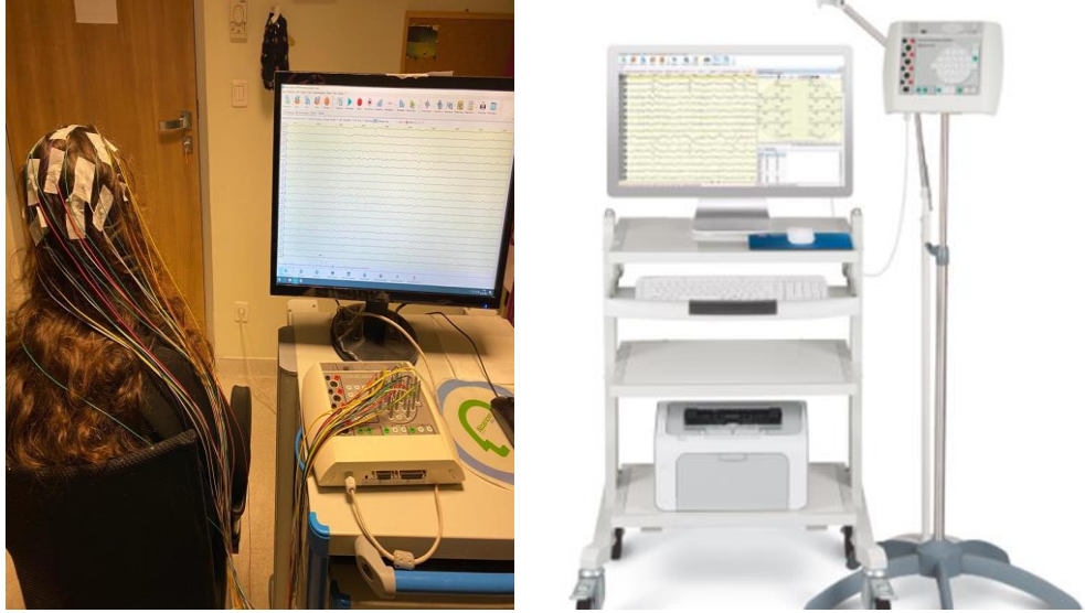
Resim: 5.6.1: Neurosoft/ NEURON-SPECTRUM 5 cihazı ile EEG kaydı
