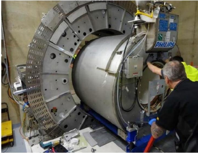
Resim 5.6.1.1 : MR görüntüleme birimi cihaza yerleştirme aşaması
