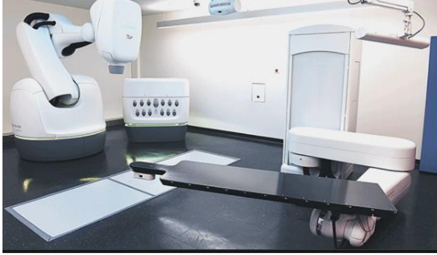
Resim 5. 1. Cyberknife M6 robotik radyocerrahi cihazı
