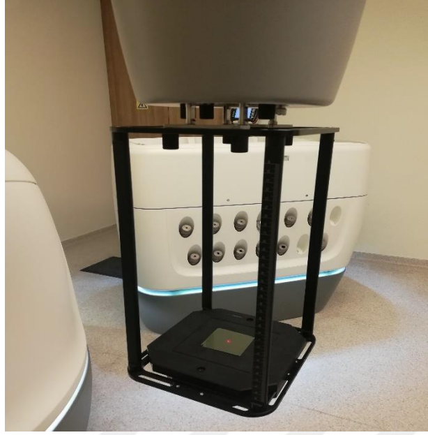
Resim 5. 13. CyberKnife cihazında film kalibrasyon eğrisi oluşturmak için ışınlanan film görüntüsü
