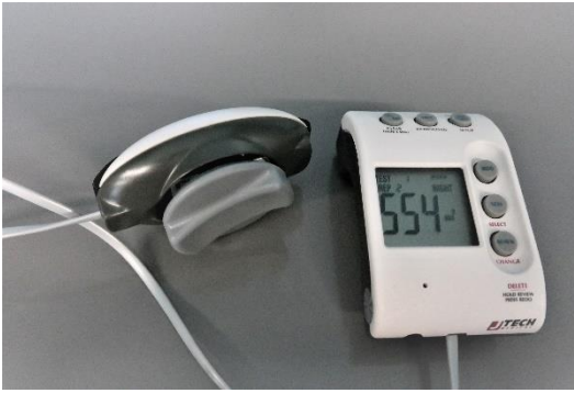
Resim 5.3.1 Dijital el dinamometresi
