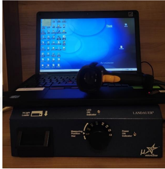
Resim 5.1.14. Microstar OSL okuyucu
