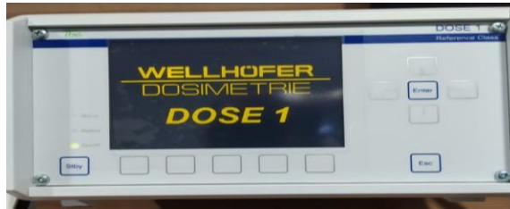
Resim 5.6: IBA Dose1 Elektrometre
