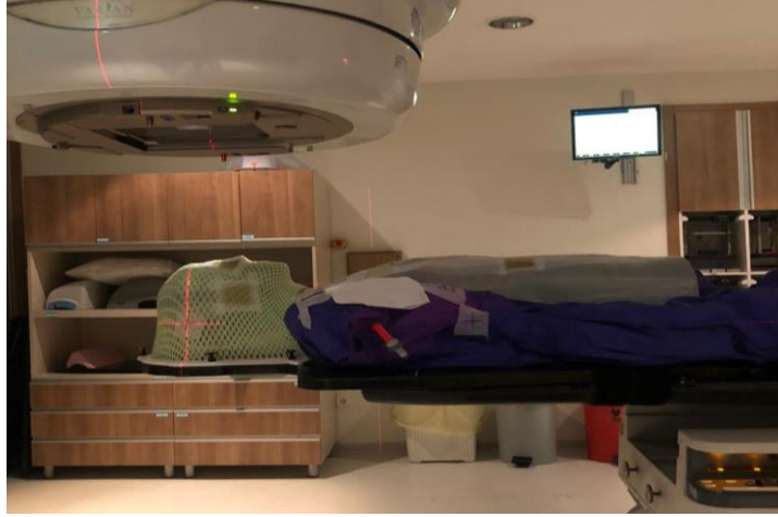
Resim 5.11: Fantomun EBT3 Film Dozimetreler ile Tedaviye Alınması
