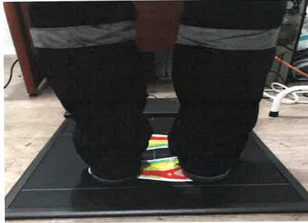
Resim 5.2.6.2. Statik pedobarografik cihazında tabanlıklılı ölçüm
