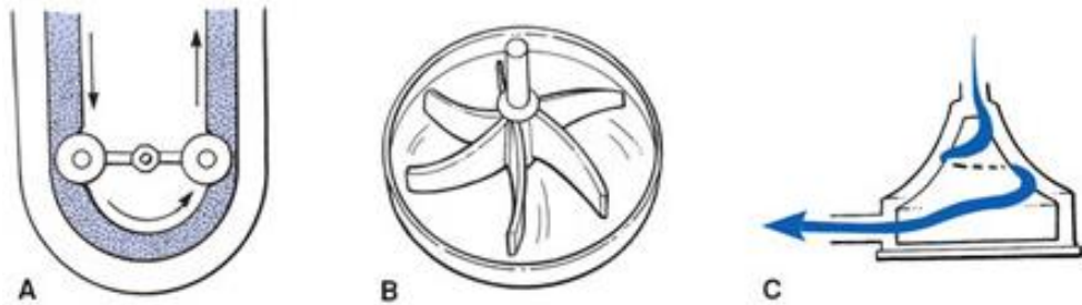
Şekil 4.2: roller pompa başlığı (A), impeller pompa başlığı (B) ve santrifugal pompa başlığı (C) (22)
